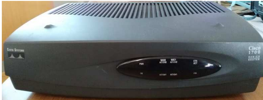
Router Cisco 1721 usato per il collegamento ad Internet tramite una rete HDSL
