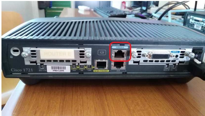
Retro del router con evidenziata la porta Console
