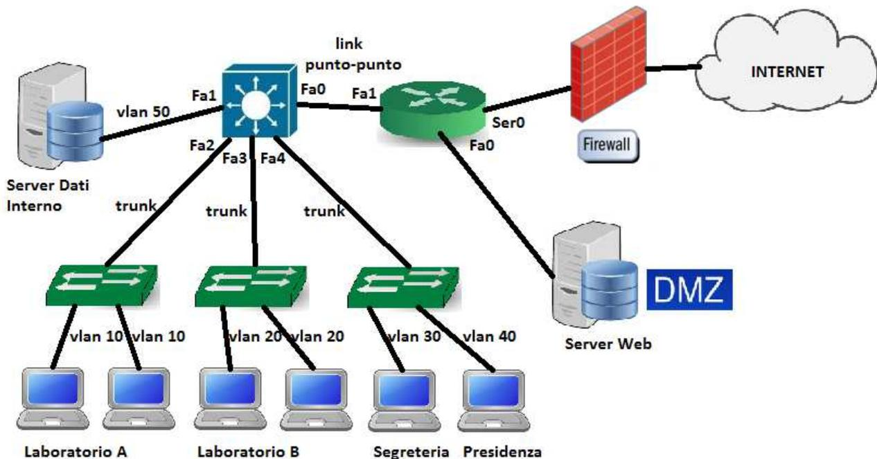
La struttura gerarchica della rete prevede al vertice uno Switch Multilayer Cisco che distribuisce la connettività ai 3 switch che interconnettono i diversi pc dei laboratori e degli uffici.
